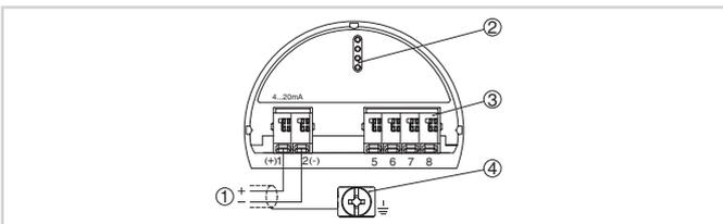
Отсек электроники и подключения (однокамерный корпус)
